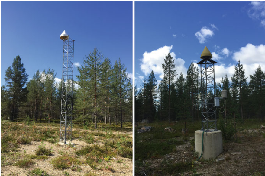
Fig. 6.4 Two GNSS systems at Sodankylä, Finland, 97 m vertical difference, 12 km apart. Left panel: antenna installed at Sodankylä Tähtelä. Right panel: antenna installed at Sodankylä Pittiövaara
