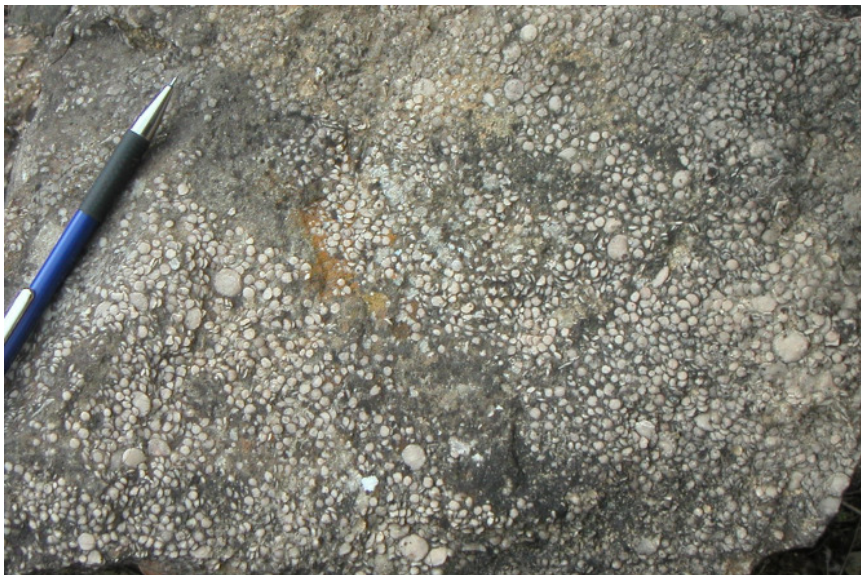
Fig. 12 - Formazione di Molare, membro arenaceo-microconglomeratico (MOR 3 ): dettaglio di un livello ricco di Nummulites fichteli in associazione monospecifica.
