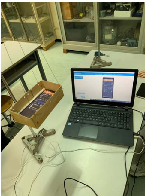
Figura 7: Misura del periodo di oscillazione del pendolo con PhyPhox al Liceo Scientifico “L. Trafelli” di Nettuno (FR), a.s. 2020/21.
