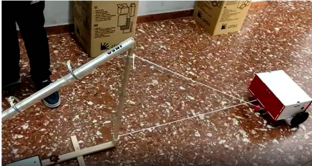
Figura 9: Robot MARRtino durante un esperimento sul piano inclinato in movimento Liceo Scientifico “ Aristotele ” di Roma, a.s. 2020/21.
