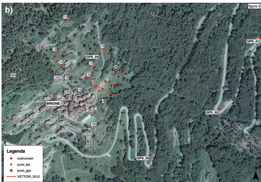
Fig. 103 - Estratto dell'ortofoto con l'ubicazione dei tubi inclinometrici (a) e dei punti di monitoraggio ottico (b) nell'area caratterizzata dal dissesto franoso nei pressi dell'abitato di Brione (DEGASPERI, 2012b). Nel riquadro di figura a) il grafico della risultante delle letture inclinometriche dal 2004 al 2008, in cui si evidenzia la superficie di scivolamento a circa 25 metri di profondità individuata dall'inclinometro n. 217.
