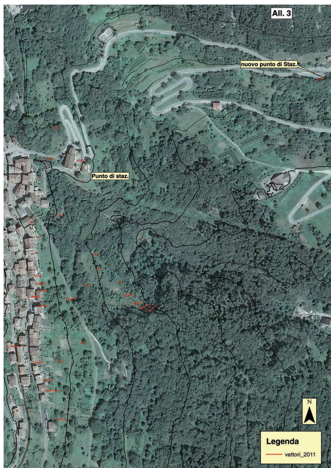
Fig. 101 - Estratto dell'ortofoto con il monitoraggio del movimento deformativo di Castel Condino, con le ubicazioni dei capisaldi e le direzioni dei vettori attendibili (DEGASPERI, 2012a).
