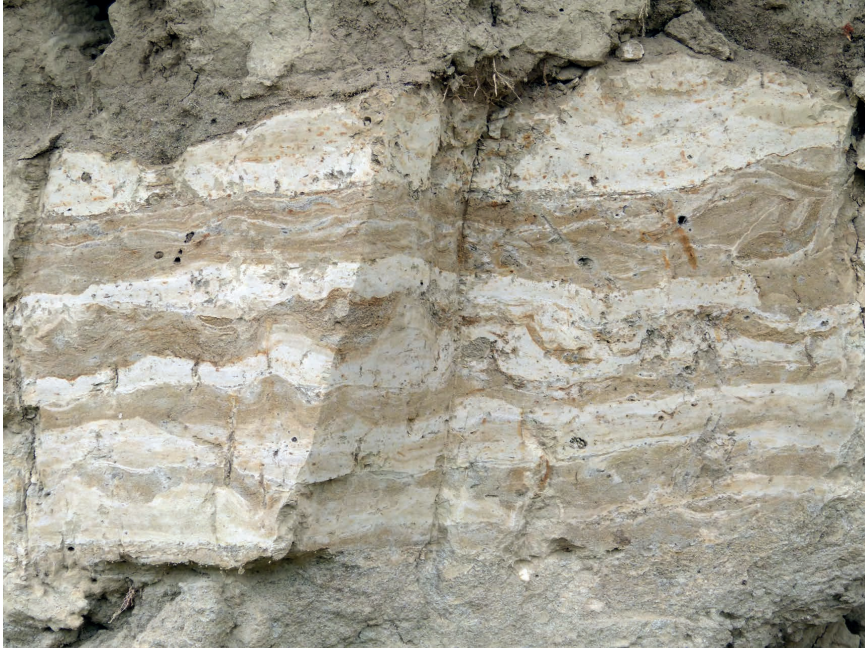
Fig. 39 - Coltri di copertura del subsistema di Dego ( CMT 2 ) affioranti lungo la sponda destra del T. Scrivia 1,2 km circa a NNO dell'abitato di Castellar Ponzano. Si osserva un'alternanza di livelli siltosi (più chiari) e sabbiosi di spessore pluricentricimetrico, diffusamente interessati da soft sediment deformation (altezza della sezione circa 50 cm).
